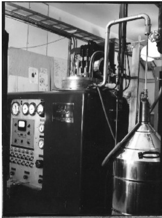
Fyllning av 25 liters flytande helium transportkärlet för för lagring och transport till olika platser i Sverige. 1957 Kurt
